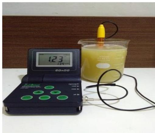
Gambar 3. Pengukuran nilai pH elektrolit FABW
