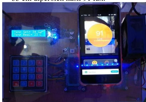
Gambar Pengukuran Intensitas Cahaya Pada Jarak 35 cm.
