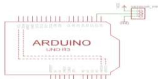
Gambar III.6 Rangkaian Sensor PIR
