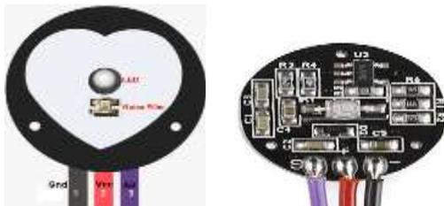
Di dalam modul sensor ini telah diintegrasikan sejumlah fungsi komponen yaitu sensor infrared, detektor cahaya, rangkaian filter, rangkaian penguat sinyal
