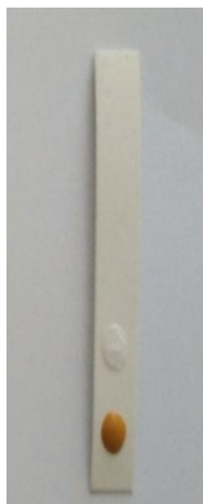
Gambar 1. Tester Borax Dengan Menggunakan Indikator Ekstrak Kunyit dan Indikator Fenoftalein.
