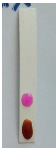
Gambar 2. Hasil Tester Menggunakan Indikator Ekstrak Kunyit dan Indikator Fenolftalein Setelah Ditetaskan Dengan Asam Borax.
