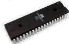
**Gambar** Bentuk Fisik Mikrokontroler ATmega 8535 Mikrokontroler AVR (*Advanced Virtual RISC*) memiliki arsitektur
