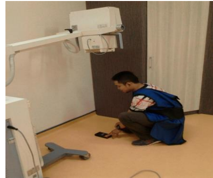
Gambar 1 Proses pengaturan jarak dan peletakan alat surveimeter
