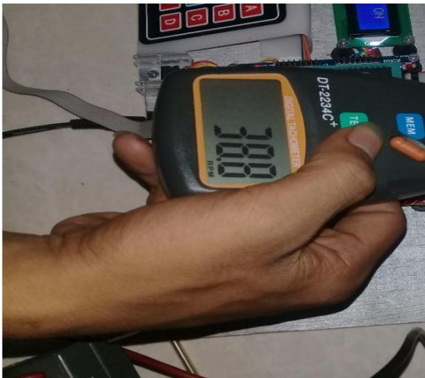
**Gambar 4.3 pengukuran kecepatan roller rpm 35**
