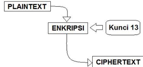
**Gambar 4.** Skema proses enkripsi ROT13
